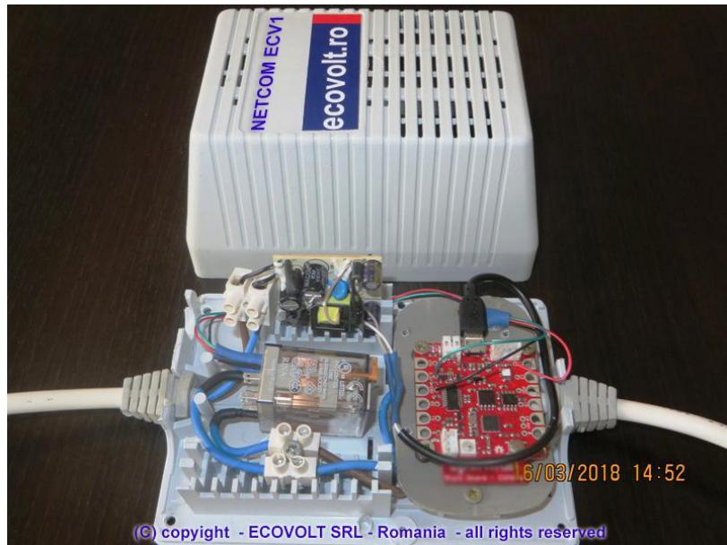
Interfata analog-digitala a sistemului, are rolul de a prelua informatiile de la senzorii externi si prelucrarea lor in vederea transmiterii datelor. Microprocesorul va prelua astfel informatiile trimise si va transmite datele prelucrate, fie prin email spre o adresa programata spre utilizator, fie spre un smartphone printr-un canal de date criptat si securizat prin internet.
