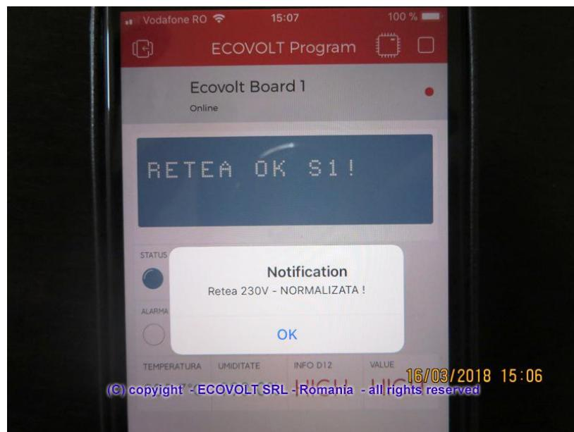
Dupa restabilirea normalitatii in functionarea sistemului de backup si revenirea parametrilor functionali, aplicatia din smartphone poate fi oprita, pentru ca ea va continua sa comunice regulat in background cu interfata NETCOM ECV1.
