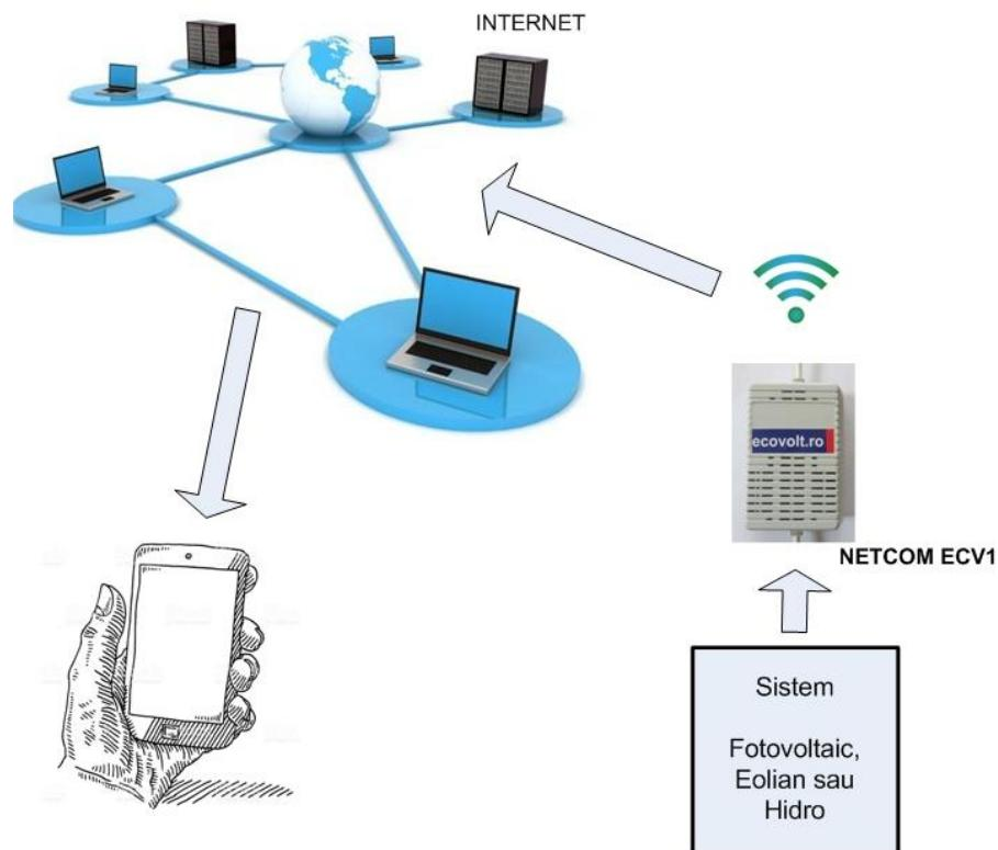
Acest sistem de comunicatii poate fi interfatat cu orice sistem fotovoltaic, eolian sau hidro, avand misiunea de a transmite pe un smartphone sau email, informații instantanee despre starea oricărui sistem, retea, generator, chiar și informații despre radiatia solară, viteza vantului, temperatura, umiditate. NETCOM ECV1 dispune de capacitatea de a transmite aproape orice informație pentru a fi procesată și comunicată prin internet.
