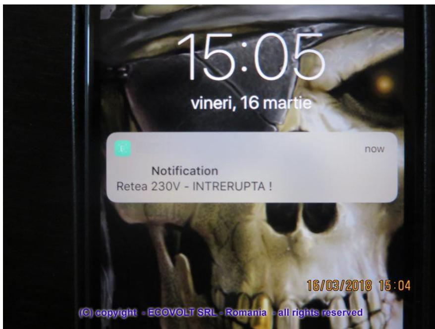
Daca in timp de 15 sec, tensiunea de la retea nu s-a normalizat si nu a revenit in parametrii normali, interfata va emite avertizarea prin telefon si email. Aceasta avertizare va fi receptionata indiferent daca aplicatia de pe telefon, este pornita sau oprita.
